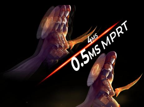
MPRT — это сокращение, означающее «время отклика движущегося изображения». Технология MPRT отключает и включает подсветку монитора во время смены изображения. Благодаря сокращению времени отображения кадра на мониторе уменьшаются эффекты ореола и размытия, что обеспечивает более плавный, более «гладкий» игровой процесс.
