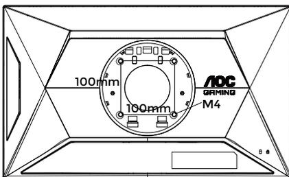
Especificações dos parafusos do suporte de parede:
