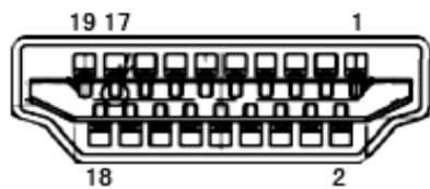
19- 引脚颜色显示信号线
