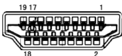
19-контактний сигнальний кабель кольорового дисплею
