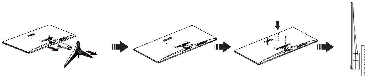
Este monitor pode ser fixado a um suporte de parede que é adquirido em separado. Desconecte a energia elétrica antes deste procedimento. Siga estas etapas:
