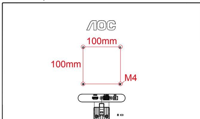
Especificações dos parafusos do suporte de parede: M4\*(9+X)mm (X=Espessura do suporte de montagem na parede)
