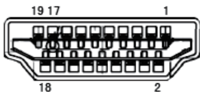
19-pinski kabel za prijenos signala u boji
