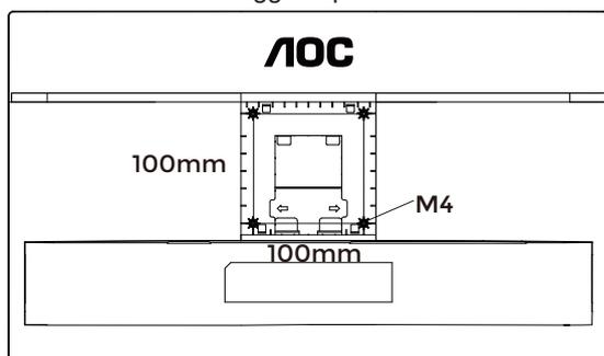
Specifiche delle viti per il supporto a parete: M4\*(10+X)mm, (X = spessore della staffa di montaggio a parete)
