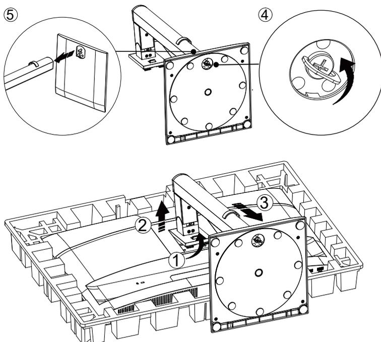
Specifiche della vite per la base: M6\*13 mm (filettatura efficace 5,5 mm)
