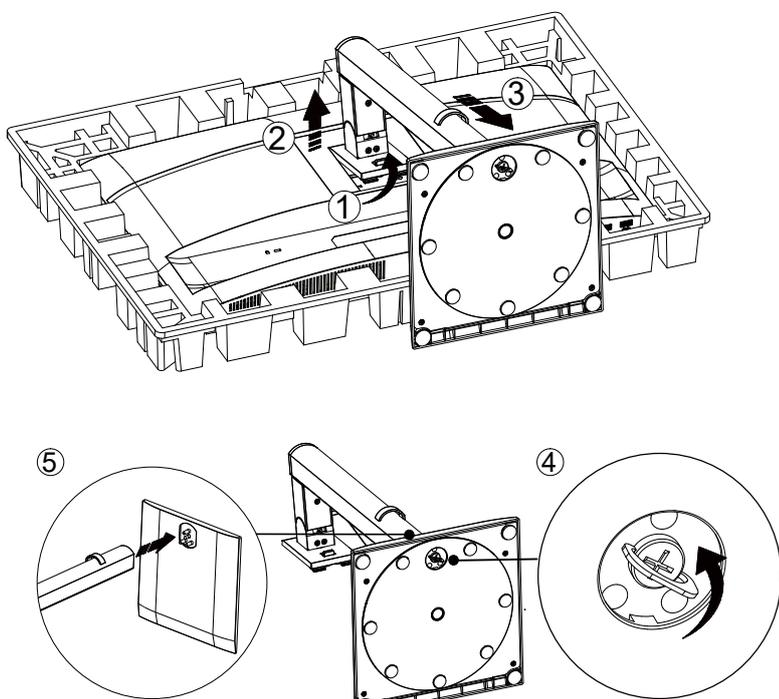
Spécification de la vis de base : M6\*13 mm (filetage effectif 5,5 mm)
