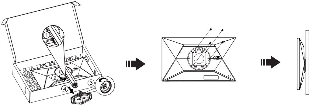
Dieser Monitor kann an einen Wandhängearm, den Sie separat kaufen können, angebracht werden. Trennen Sie bitte vor der Installation die Stromversorgung. Folgen Sie dann den Schritten unten:
