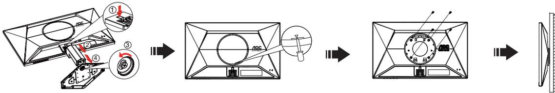
Este monitor pode ser montado num braço de fixação para parede, adquirido separadamente. Desconecte o cabo de alimentação antes deste procedimento. Siga os passos abaixo:
