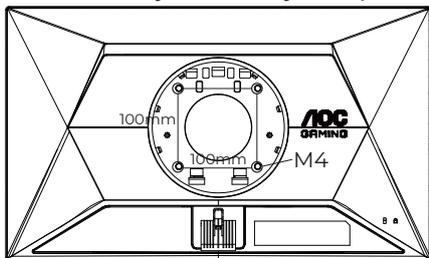
Especificação dos parafusos de montagem na parede:
