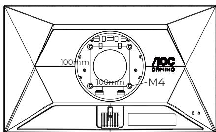
Технически характеристики на винтове за окачване на стена:
