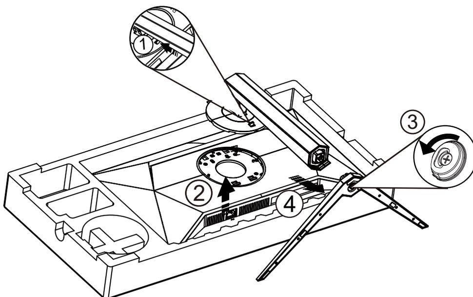
Spécification pour la vis de la base : M6\*23 mm (filetage effectif 5,5 mm)
