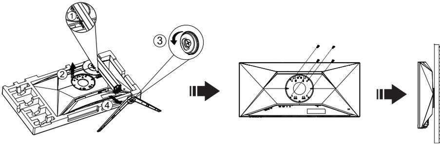
Este monitor puede adjuntarse a un brazo para montaje en la pared que adquiera por separado. Desconecte al corriente antes de este procedimiento. Siga estos pasos:
