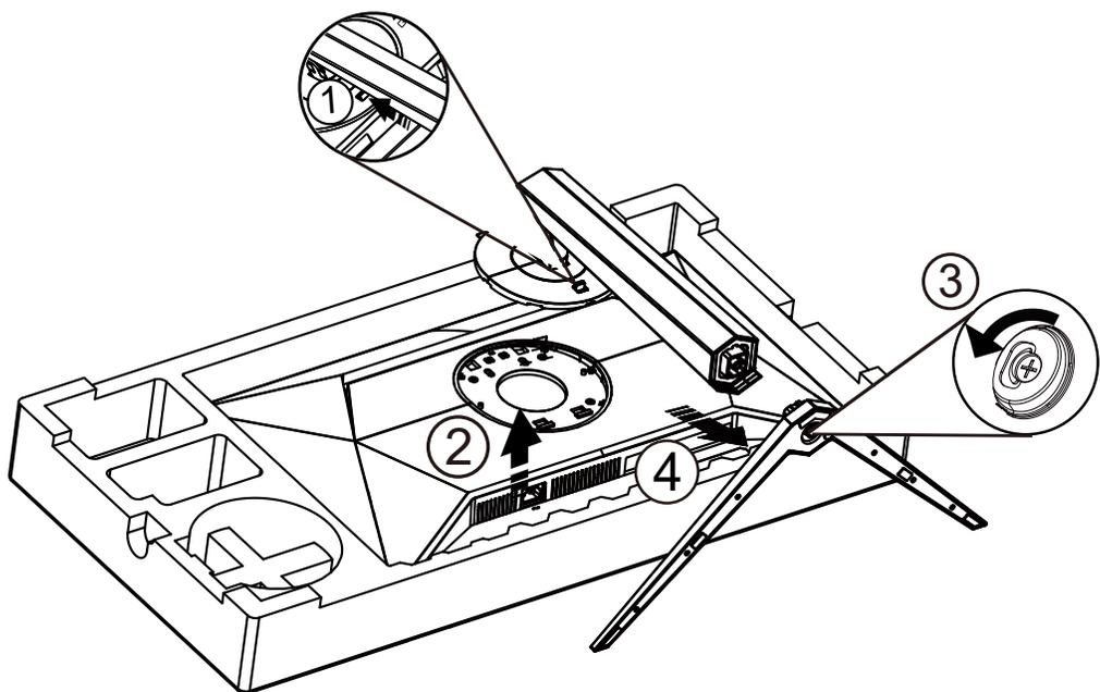
Especificações dos parafusos da base: M6\*23 mm (rosca 5,5 mm)
