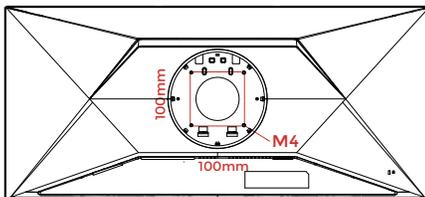
Especificações dos parafusos do suporte de parede:
