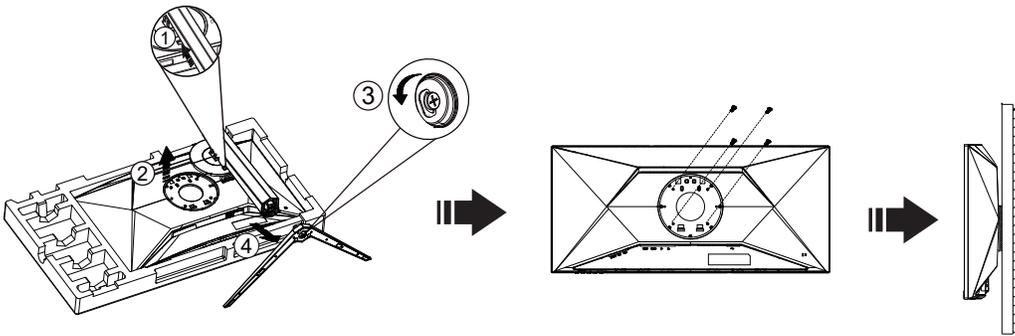
Este monitor pode ser fixado a um suporte de parede que é adquirido em separado. Desconecte a energia elétrica antes deste procedimento. Siga estas etapas:
