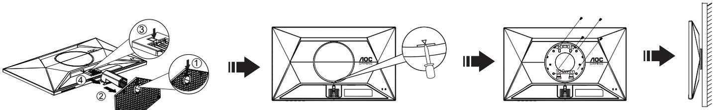
Este monitor pode ser fixado a um suporte de parede que é adquirido em separado. Desconecte a energia elétrica antes deste procedimento. Siga estas etapas:
