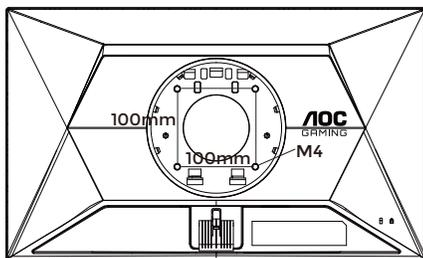
Especificações dos parafusos do suporte de parede:
