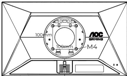
Especificação dos parafusos de montagem na parede:
