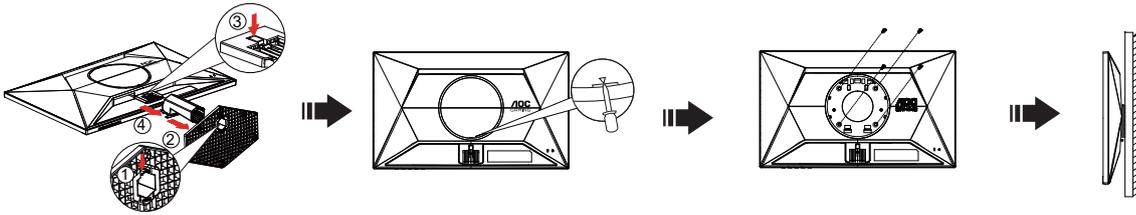
Este monitor pode ser montado num braço de fixação para parede, adquirido separadamente. Desconecte o cabo de alimentação antes deste procedimento. Siga os passos abaixo:
