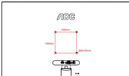
壁掛けハンガーのネジ仕様：M4\*(10+X)mm (X= 壁掛けブラケットの厚み)
