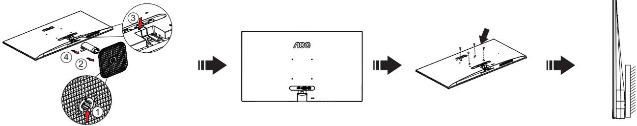
本モニターは、別売りの壁面取り付けアームに据え付けることができます。準備をする前に、電源を切断します。次の手順に従います：
