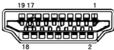
Kabel Sinyal Layar Warna 19-Pin
