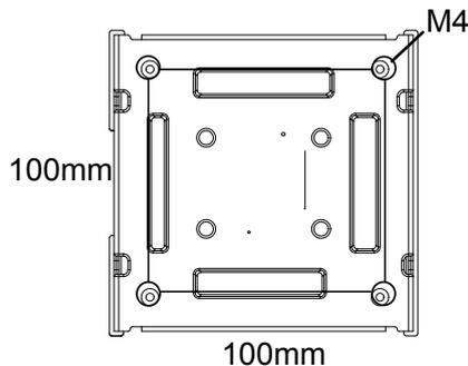
Especificación de tornillos del colgador para pared: M4\*12mm
