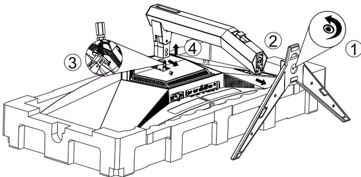
Especificaciones del tornillo de la base: M6\*21 mm (rosca efectiva de 5,5 mm)
