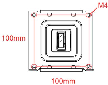
壁挂孔螺丝规格：M4\*(12+X)mm (X= 壁挂架铁件厚度)    底座螺丝规格：M6\*12mm (有效牙纹 5.5mm)
