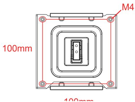
Спецификация винтов для настенного крепления: M4\*12mm
