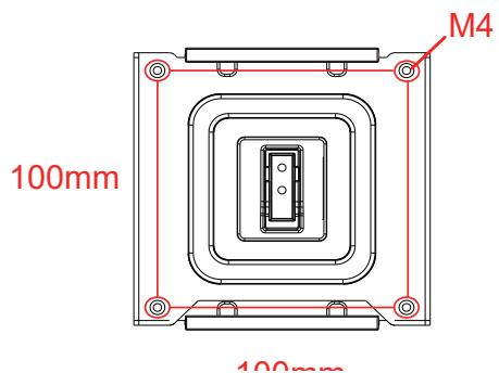
Спецификация винтов для настенного крепления: M4\*12mm
