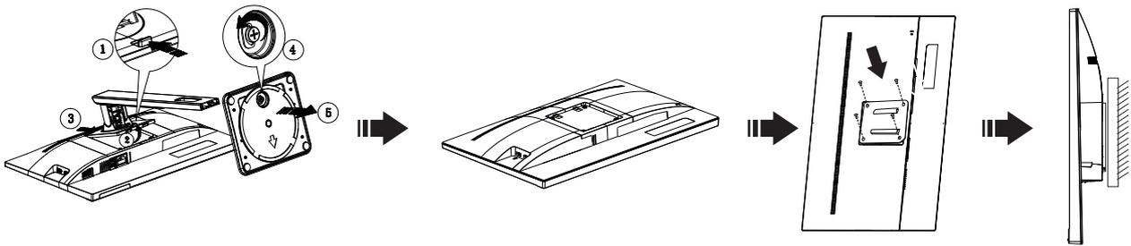
Dieser Monitor kann an einen Wandhängearm, den Sie separat kaufen können, angebracht werden. Trennen Sie bitte vor der Installation die Stromversorgung. Folgen Sie dann den Schritten unten:
