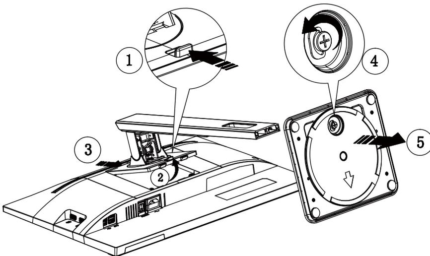
Spezifikation für Basisschraube: M6\*16 mm (effektives Gewinde 5.8 mm)
