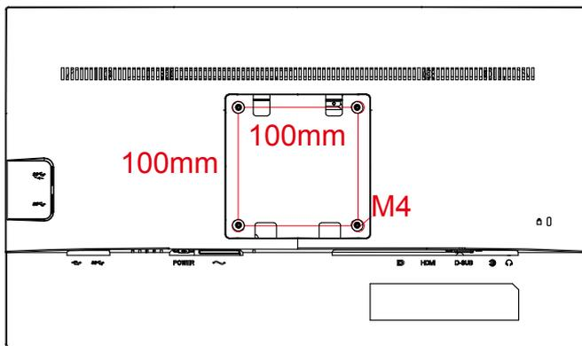
Spezifikation der Wandhalterschrauben M4\*(10+X)mm, (( X=Dicke der Wandhalterung)
