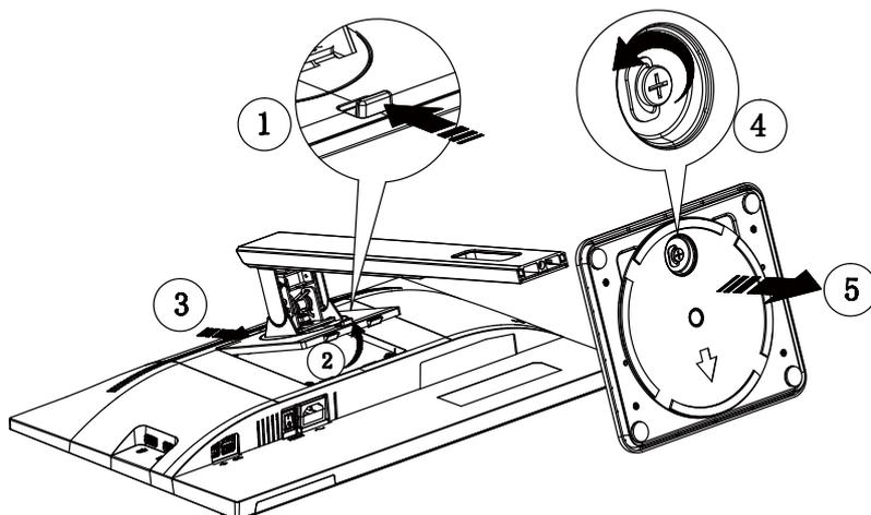
Spécifications de la vis de base: M6 \* 13 mm (filetage effectif 5,8 mm)
