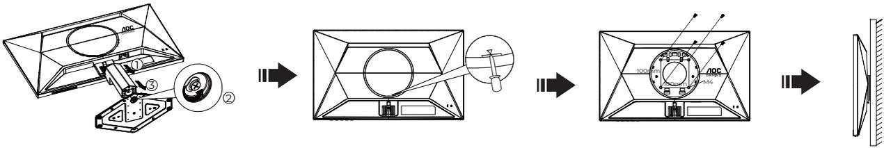
Dieser Monitor kann an einen Wandhängearm, den Sie separat kaufen können, angebracht werden. Trennen Sie bitte vor der Installation die Stromversorgung. Folgen Sie dann den Schritten unten:
