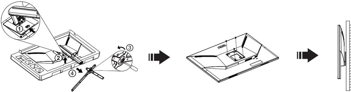
Este monitor puede adjuntarse a un brazo para montaje en la pared que adquiera por separado. Desconecte al corriente antes de este procedimiento. Siga estos pasos:
