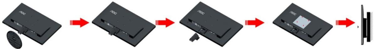
Monitor ini dapat dipasangkan ke lengan pemasangan untuk di dinding yang dapat dibeli terpisah. Lepas kabel daya sebelum melakukan prosedur ini. Ikuti langkah-langkah berikut:
