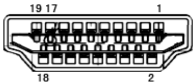
19- 引脚颜色显示信号线
