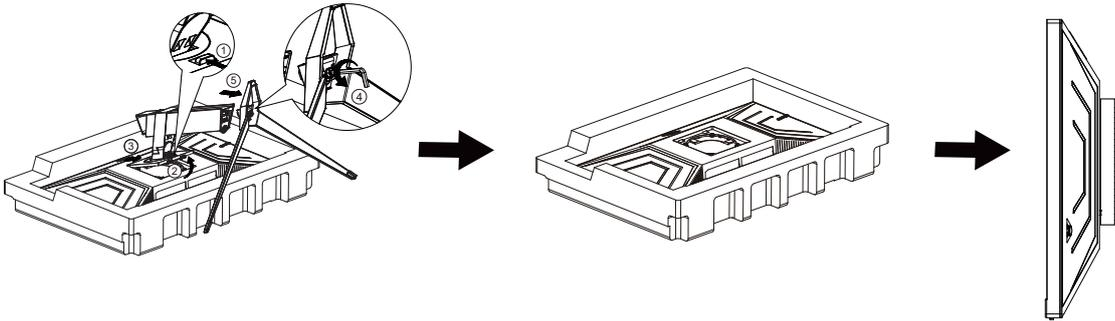
本顯示器可安裝於另購的壁掛支架。安裝前請先拔下電源線。按下列步驟進行：
