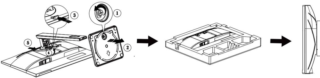
Dieser Monitor kann an einen Wandhängearm, den Sie separat kaufen können, angebracht werden. Trennen Sie bitte vor der Installation die Stromversorgung. Folgen Sie dann den Schritten unten:
