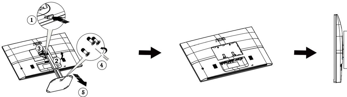
Dieser Monitor kann an einen Wandhängearm, den Sie separat kaufen können, angebracht werden. Trennen Sie bitte vor der Installation die Stromversorgung. Folgen Sie dann den Schritten unten:
