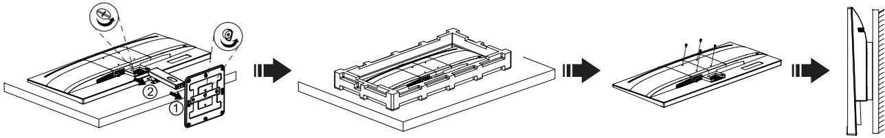
Este monitor pode ser montado num braço de fixação para parede, adquirido separadamente. Desconecte o cabo de alimentação antes deste procedimento. Siga os passos abaixo:
