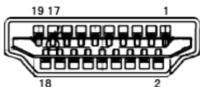
19kolíkový kabel signálu pro barevný monitor
