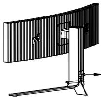
② Retire a trava de metal conforme seta
