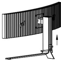
① Levante a trava de metal conforme a seta
