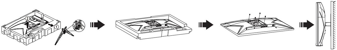
Este monitor puede adjuntarse a un brazo para montaje en la pared que adquiera por separado. Desconecte al corriente antes de este procedimiento. Siga estos pasos:
