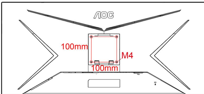
Especificación del tornillo montado en la pared M4 \* (10 + x) mm, (x = espesor del soporte montado en la pared)
