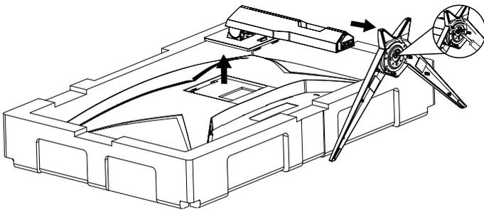
Especificación del tornillo de base: M6 \* 13 MM (hilo efectivo 5,5 mm)
