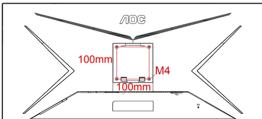
壁掛けネジ M4\* (10+X) mm の仕様、(X = 壁掛けブラケットの厚さ)
