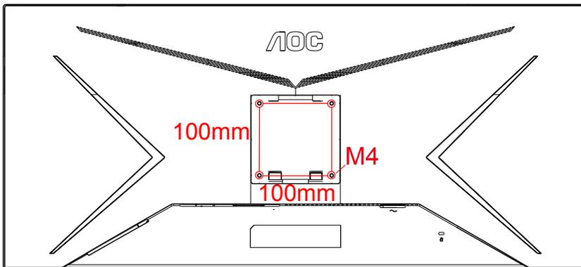
Especificação dos parafusos M4\* (10 + X) mm do gancho de parede, (X = Espessura do suporte da montagem na parede)
