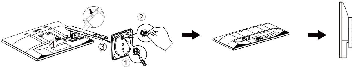
Dieser Monitor kann an einen Wandhängearm, den Sie separat kaufen können, angebracht werden. Trennen Sie bitte vor der Installation die Stromversorgung. Folgen Sie dann den Schritten unten:
