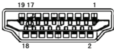
Cabo de sinal de monitor a cores de 19 pinos
