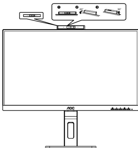
Remarque : Tournez l'objectif vers le bas à 90° pour bloquer l'objectif. Le microphone peut être désactivé en utilisant le logiciel vidéo ou la touche de raccourci MIC OFF.
