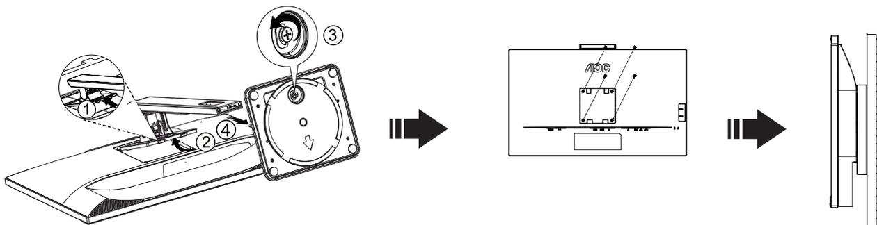
Este monitor pode ser fixado a um suporte de parede que é adquirido em separado. Desconecte a energia elétrica antes deste procedimento. Siga estas etapas:
