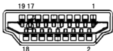
19-контактный кабель для передачи сигналов цветного изображения
