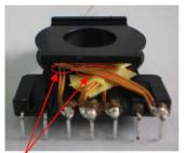
次级绕组TAPE适当加宽为5.5mm或在次级侧三层线上贴一层宽度为4.5mm的TAPE,使得TAPE向三层线方向偏移约1mm贴到三层线上或直接贴TAPE在三层线上。
