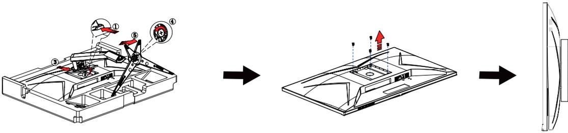
Este monitor puede adjuntarse a un brazo para montaje en la pared que adquiera por separado. Desconecte al corriente antes de este procedimiento. Siga estos pasos:
