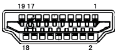
19-ben kabel til farveskærme
