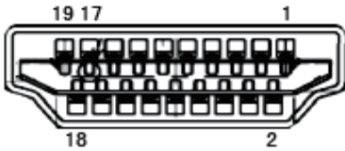
Câble de signal d'affichage couleur à 19 broches
