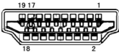
Câble de signal d'affichage couleur à 19 broches
