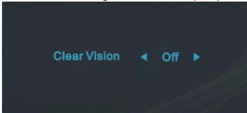
3. Halten Sie die „<-Taste zum Aktivieren der Clear Vision-Demo 5 Sekunden gedrückt und die Meldung „Clear Vision-Demo: on“ (Clear Vision-Demo: Ein) erscheint 5 Sekunden lang im Display. Halten Sie die „<-Taste noch einmal 5 Sekunden gedrückt und Clear Vision-Demo wird deaktiviert.
