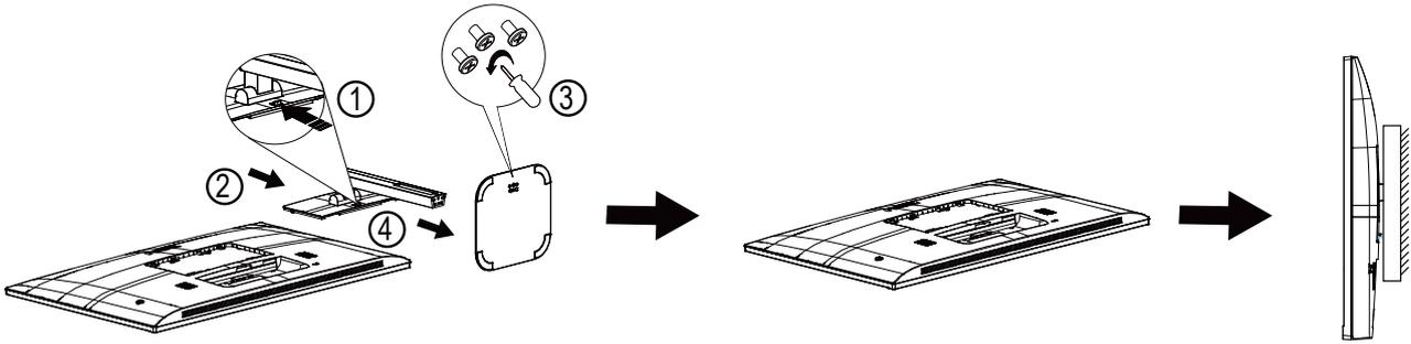
Este monitor puede adjuntarse a un brazo para montaje en la pared que adquiera por separado. Desconecte al corriente antes de este procedimiento. Siga estos pasos:
