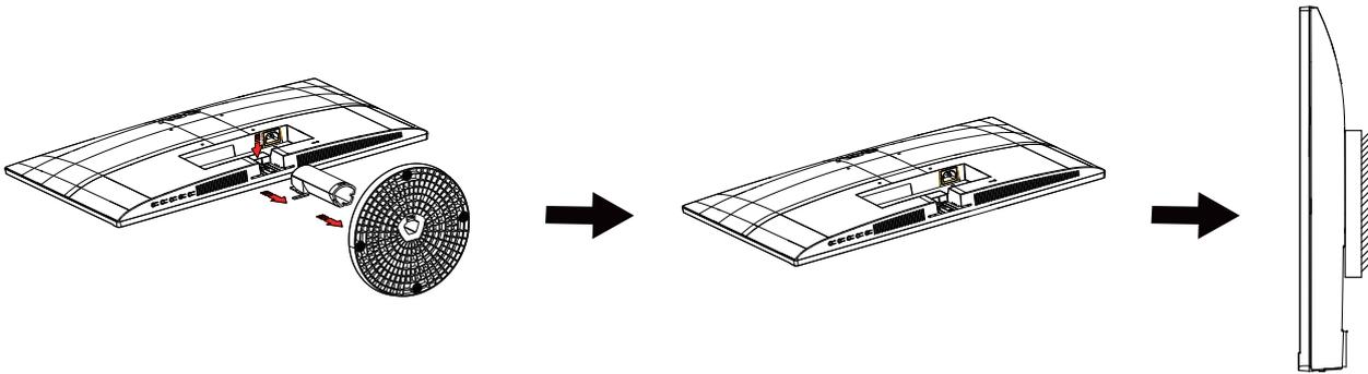
Dieser Monitor kann an einen Wandhängearm, den Sie separat kaufen können, angebracht werden. Trennen Sie bitte vor der Installation die Stromversorgung. Folgen Sie dann den Schritten unten:
