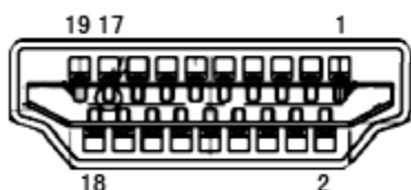
19 - полюсен сигнален кабел за цветен монитор
